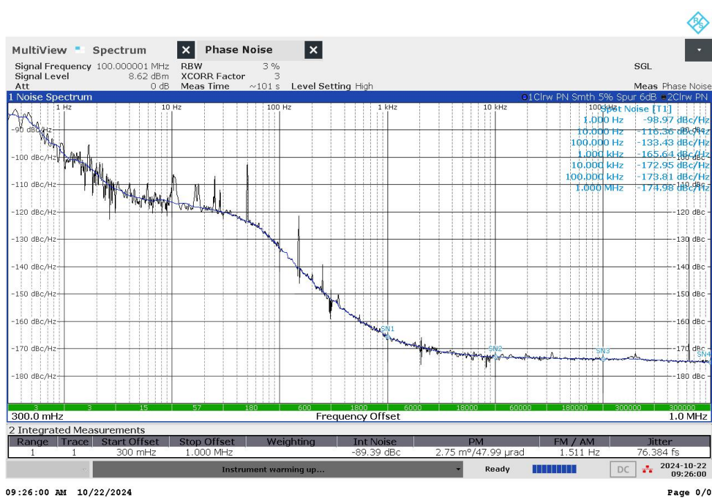
100MHz 相位噪声测试图
